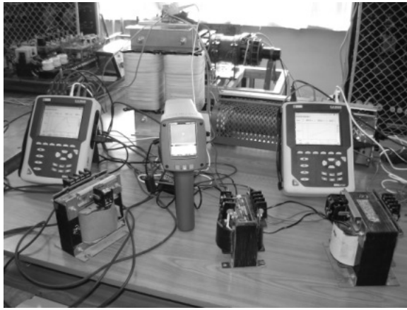
Fig. 2 – Standuri pentru studiul bilanțului electroenergetic al transformatorului, motorului asincron și condensatorului
